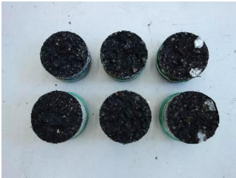
写真 24 水 浸 引 張 接 着 試 験 の 破 壊 状 況
