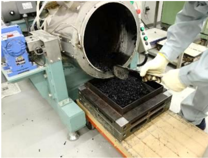
写真3 試験体作製状況（アスファルト混合物の敷設） [引張接着試験用，せん断試験用及び水浸引張接着試験用]
