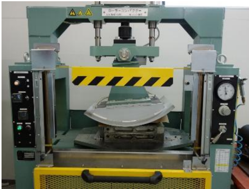
写真 5 試験体作製状況（アスファルト混合物の締固め） [引張接着試験用，せん断試験用及び水浸引張接着試験用]
