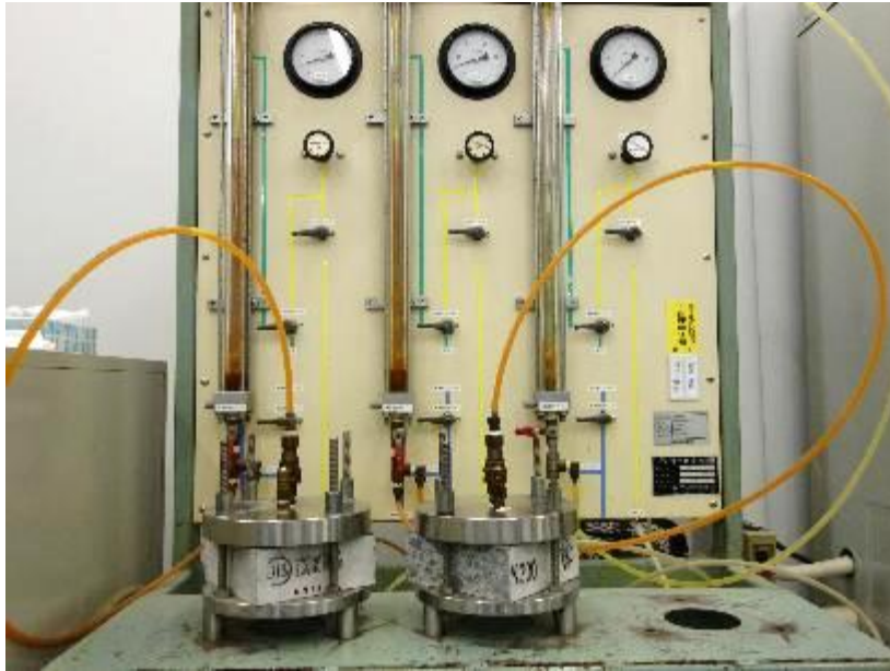
写真14 防水性試験 I 試験状況
