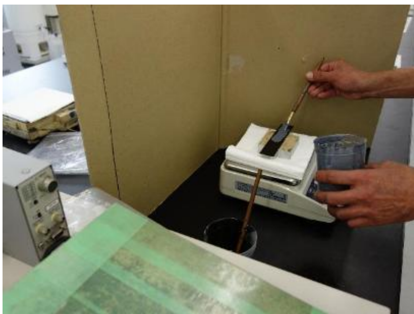
写真 7 試験体作製状況（防水材の塗布） [ひび割れ追従性試験Ⅰ用]
