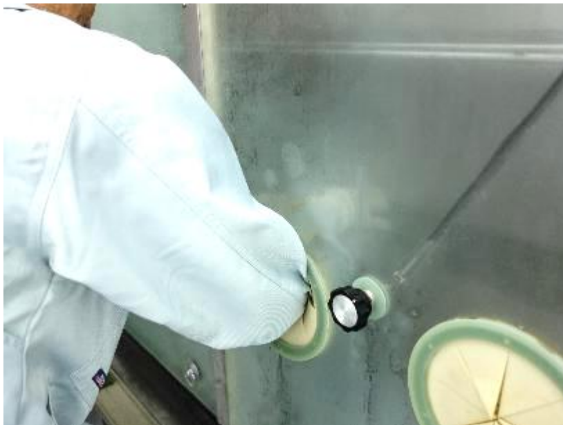
写真15 ひび割れ追従性試験 I 試験状況
