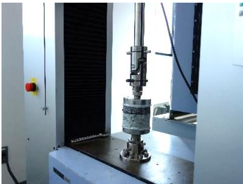
写真16 引張接着試験状況（試験温度23℃の例）
