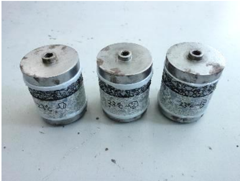
写真 9 試験前の試験体 [引張接着試験用 (試験温度 23℃)]
