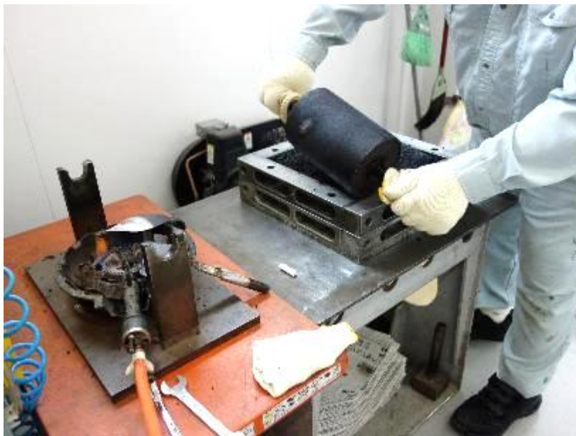
写真4 試験体作製状況（アスファルト混合物の成型） [引張接着試験用，せん断試験用及び水浸引張接着試験用]
