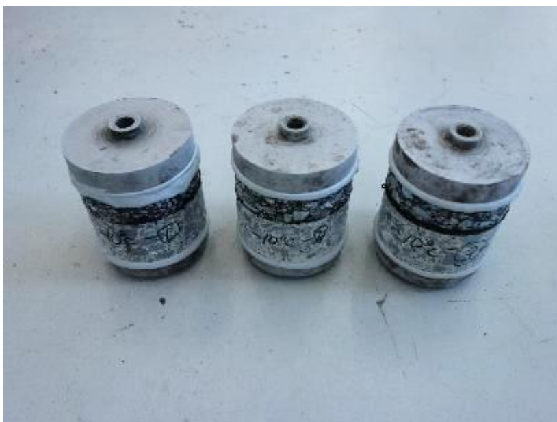
写真 10 試験前の試験体 [引張接着試験用 (試験温度-10℃)]
