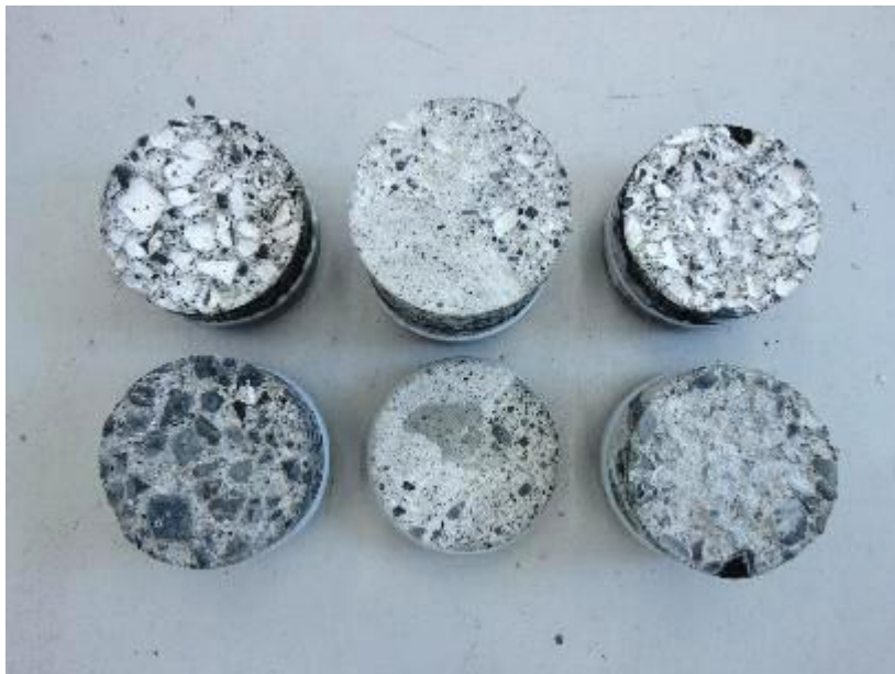
写真 21 引張接着試験後の試験体 [試験温度-10℃]
