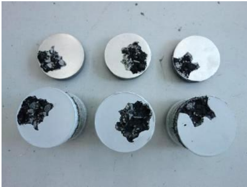
写真 20 引張接着試験後の試験体 [試験温度 23℃]
