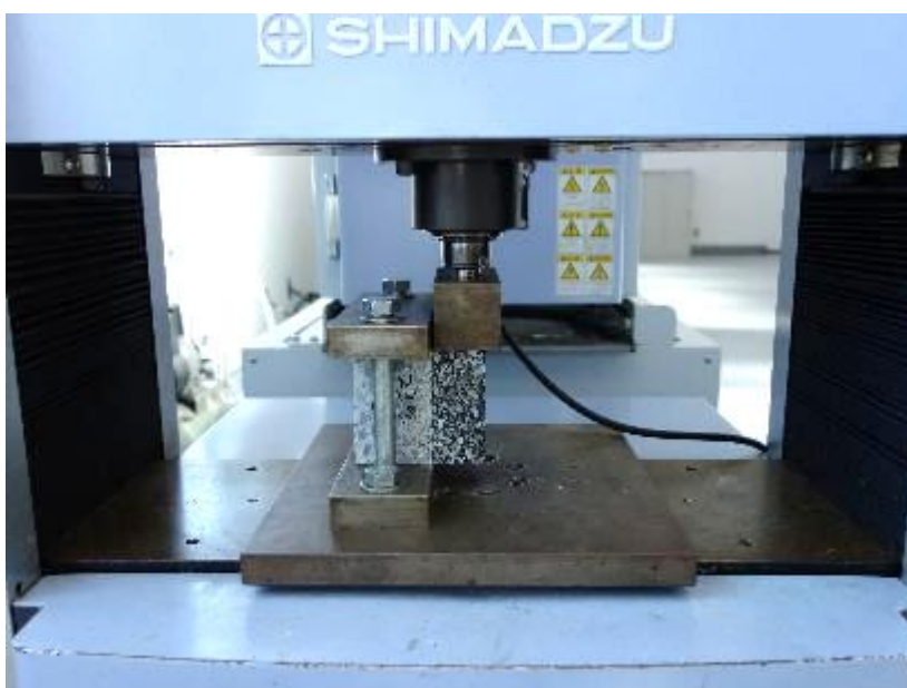
写真17 せん断試験状況（試験温度23℃の例）
