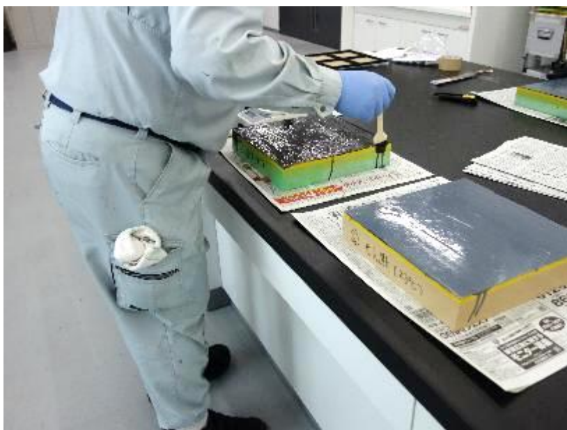
写真 1 試験体作製状況（防水材の塗布）
