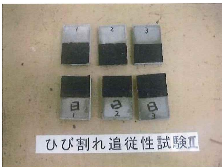
試験後の試験体
