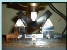
『エポックグース』は、バイнда自体が高い可撓性を有しています。そのため、『エポックグース』を用いたグースアスファルト混合物に高い柔軟性を付与します。
